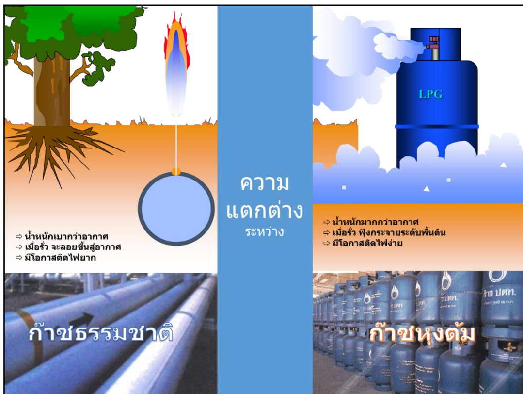
รูปที่ 4.8-5 : ตัวอย่างความแตกต่างเมื่อเกิดการรั่วไหลระหว่างก๊าซธรรมชาติและก๊าซหุงต้ม
